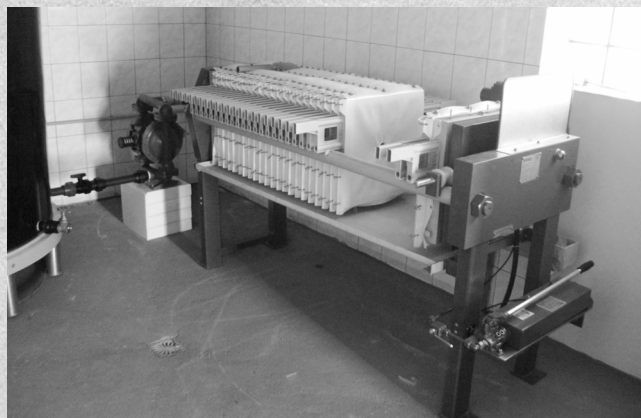
MODERNÍ KALOLIS SE DNES POUŽÍVÁ I V OBCENÍ ČISTIČCE OPADNÍCH VOD VE STRUHAŘOVĚ.
